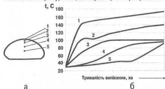
Рис. 8.2. Умовно виділені шари тістової заготовки (а) і приблизна кінетика температури окремих шарів тістової заготовки при випіканні (б): 1 — поверхневий шар, 2 — шар під поверхневим, 3 — шар, що граничить між скоринкою і мякушкою (зона випаровування), 4 — шар між зоною випаровування і центром тістової заготовки, 5 — центр тістової заготовки
