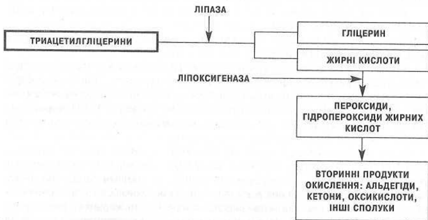
Рис. 3.13. Загальна схема ферментативного гідролізу жирів
