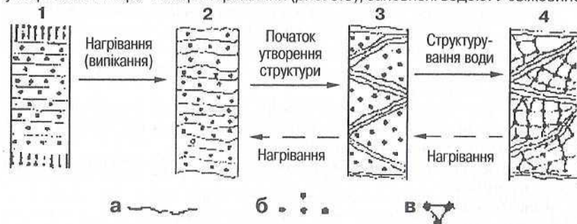
Рис. 9.5. Схема Княгінчева, що пояснює зміни крохмалю і вологи хліба під час черствіння: а — ланцюги макромолекул крохмалю; б — вільні молекули води; в — молекули води, що утворюють ущільнену структуру, 1 — слабо набухлий крохмаль (тісто), 2 — сильно набухлий крохмаль (свіжовипечений хліб), 3 — гель на початку утворення кристалічної структури (початок черствіння хліба), 4 — гель з кристалічною структурою (черствий хліб)
