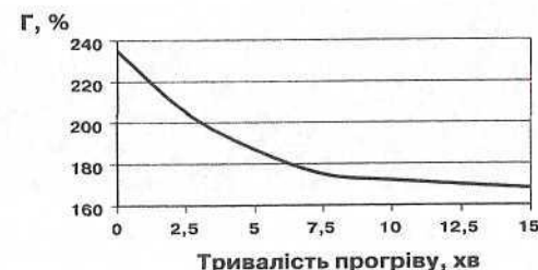
Рис. 8.5. Зміна гідраційної здатності білків при нагріванні (температура 100°С)
